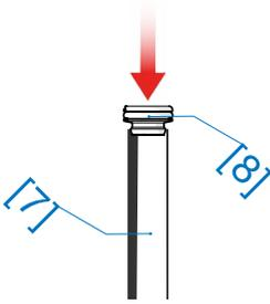
► Posizionare l'unità cuscinetto [8] insieme alla sede del cuscinetto [7] sull'ausilio per il montaggio. **CONSIGLIO:** invece dell'ausilio per il montaggio è possibile utilizzare anche una penna a sfera
