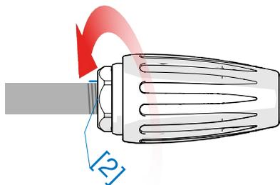
► Avvitare l'ugello rotante sulla lancia ad alta pressione per mezzo della filettatura di collegamento [2].
