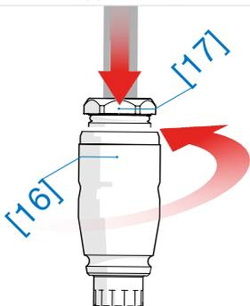
**Sostituzione dell'O-ring sulla spina di trasmissione**
