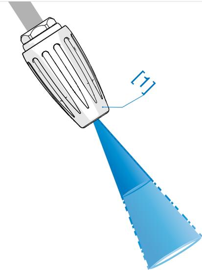
Rotordüse beim Öffnen der Hochdruckpistole
